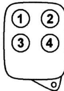
**Пример 2:** двойное нажатие кнопки 3 ручного передатчика СН4Н с присвоенным выходом 4 приёмника, выбранным на шаге 2 выше, запрограммирует первые три кнопки на приёмник. Теперь кнопка 3 управляет выходом 4, кнопка 2 – выходом 3, а кнопка 1 – выходом 2. Кнопка 4 этого передатчика не будет активна для данного приёмника.
